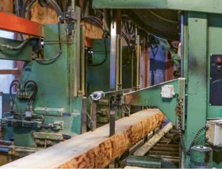
Einschnitt Rundholz. Der Einschnitt mit der Bandsäge ist sehr flexibel und ermöglicht so eine optimale Ausnutzung jedes Stamms.
